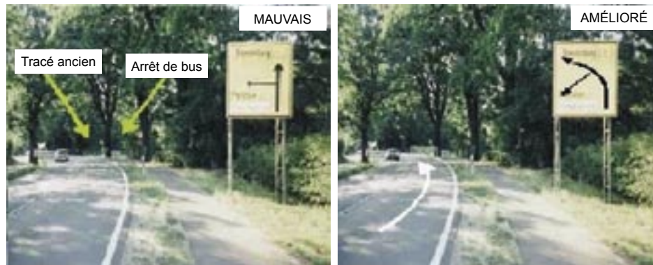
Figure 50 : la signalisation montre une autre direction que le tracé actuel, certains conducteurs tentent de suivre l'ancien tracé [22]
