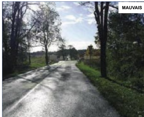
Figure 9 : intersection non visible 125 m avant : freinage inattendu et vitesse trop élevée causent des collisions par l'arrière [16]
