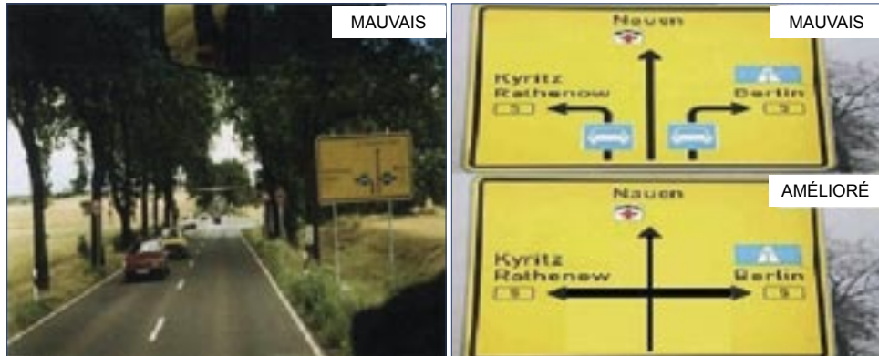
Figure 52 : Attente erronée de la situation rencontrée du fait de signaux trompeurs à une zone accidentogène [16]
